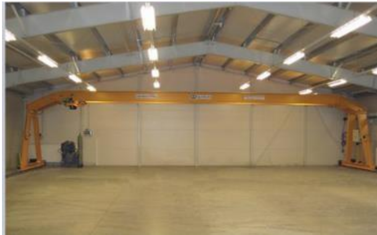
6,3 t-ás beltéri bakdaru maximális helykihasználással
